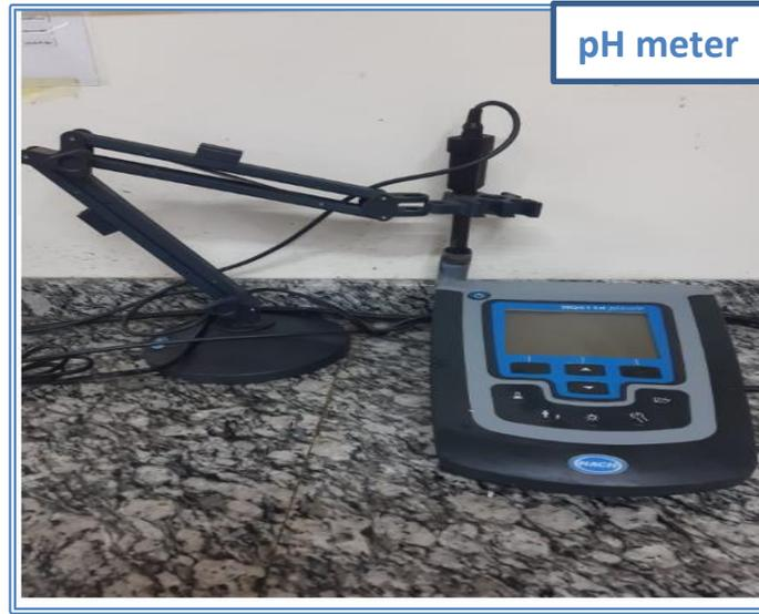
أداة تستخدم لقياس الأس الهيدروجيني (درجة الحموضة
