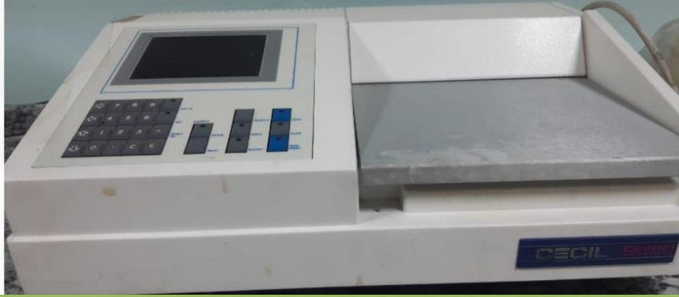
يستخدم لقراءة الامتصاص للمركبات ولتقدير تركيز المركبات في المحاليل باستخدام خاصية الطيف.. المبدأ الاساسي لهذا الجهاز هو ان المركب المراد قياسه يمتص او يعكس الضوء من خلال مدى محدد من الاطوال الموجية حيث يقوم الجهاز بقياس كمية الفوتونات الممتصة من قبل العينة عند مرور الضوء خلالها وبالتالي نحصل على تركيز المادة المراد فحصها من خلال عمل ستاندر قياسي
