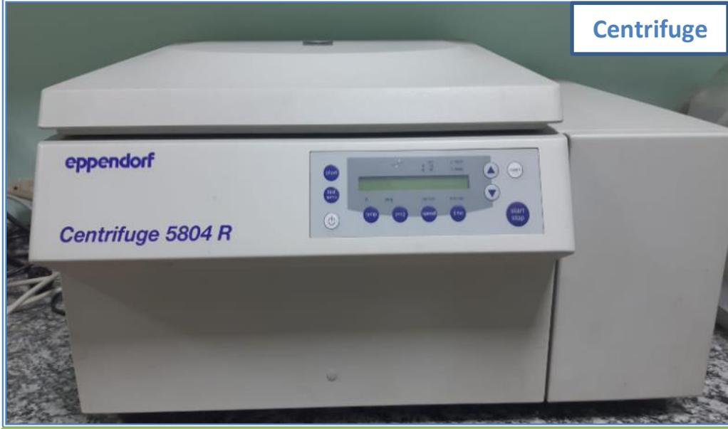
جهاز الطرد المركزي المبرد بسرعة 14000 دورة في الدقيقة يستخدم لفصل المكونات المختلفة للسوائل تحت التبريد يعتمد على مبدأ الترسيب للمكونات حسب كثافتها اذ تترسب المواد الاثقل الى الاسفل مع ظهور الراشح الى الاعلى
